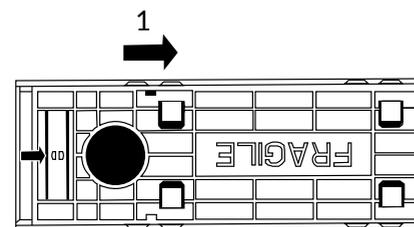
Pour ne changer que le panneau, sans déclipper le cadre du support ou du coffre, faites glisser le capot du cadre sur la gauche ou la droite (1).
