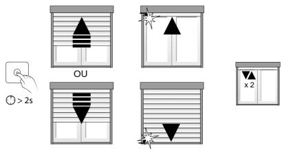
Appuyez sur le bouton poussoir (> 2 secondes) pour que le moteur s'actionne dans le sens inverse.
