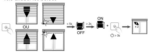
Appuyez une fois sur le bouton poussoir pour que le volet s'actionne vers le bas ou vers le haut. Coupez le secteur dans les 5 secondes suivant l'arrêt du moteur en butée haute ou basse.
