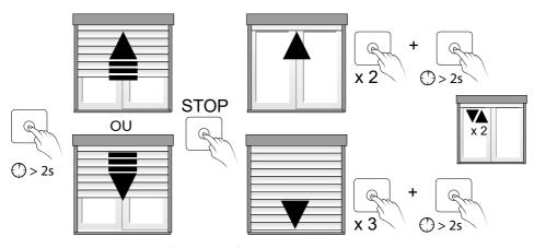
Appuyez sur le bouton poussoir (> 2 secondes) pour que le moteur s'actionne dans le sens inverse. Faire un appui bref pour le stopper à la position correspondante à la butée manuelle.
