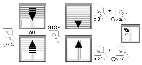
Appuyez sur le bouton poussoir (> 2 secondes) pour que le moteur s'actionne dans le sens inverse. Faire un appui bref pour le stopper à la position correspondante à la butée manuelle.
