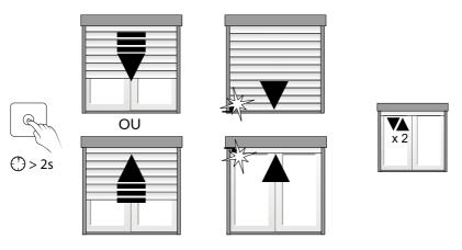
Faire un appui long sur le bouton poussoir (> 2 secondes) pour que le moteur s'actionne dans le sens inverse.
