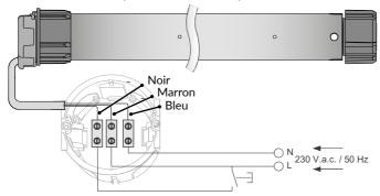
Lorsque les butées ne sont pas programmées sur le moteur, il faut rester appuyé plus d'1 seconde sur le bouton poussoir.
