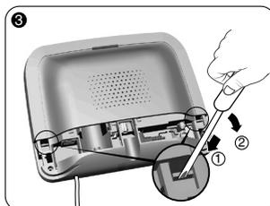
A l'aide d'un tournevis, soulevez les 2 clips maintenant le capot supérieur.
