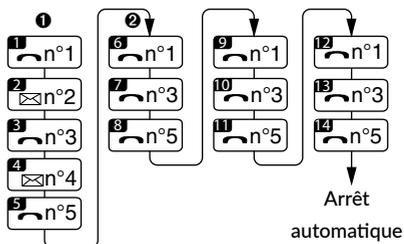
Un numéro programmé avec option de diffusion SMS recevra automatiquement le lien vidéo lors d'une intrusion. (sur détection d'un DMBV TYXAL+)
